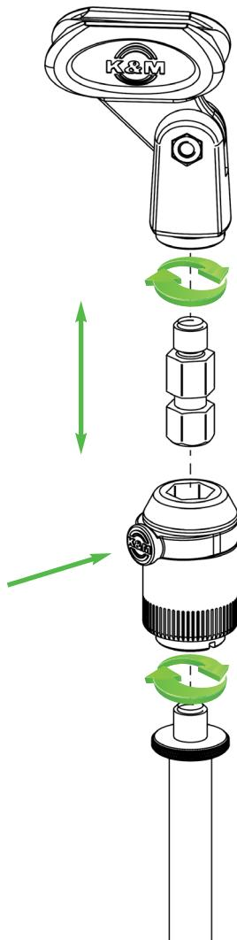
Zum Entfernen des Gewindegelenks oder späterem Tausch des Equipment, auf das K&M Logo des grauen Verriegelungsringes drücken und den Gewindegelenk nach oben aus dem Quick-Release Adapter entfernen.
